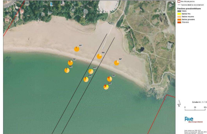
FRACTIONS GRANULOMÉTRIQUES POUR LE SUBSTRAT MEUBLE Suivi écologique des travaux en mer - Raccordement du parc éolien en mer de Saint-Nazaire
